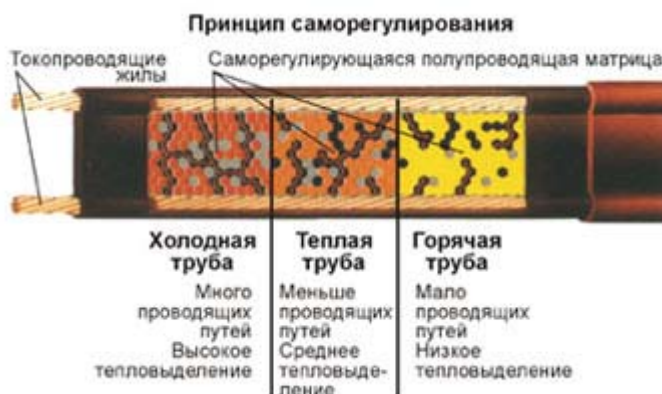
Рис.4. Принцип работы саморегулирующейся тепловыделяющей матрицы.
